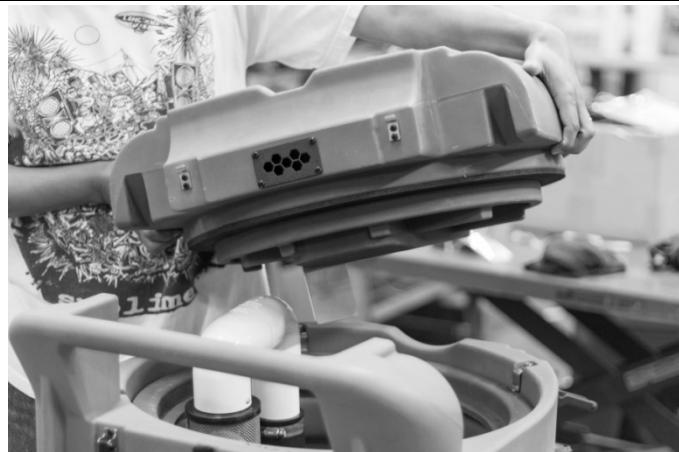
Desserrez le serre-câble sur la paroi intérieure du réservoir avec la clé 15 ou 16 po et repliez environ deux pieds de cordon, ou jusqu'à ce que le cordon commence à résister.
