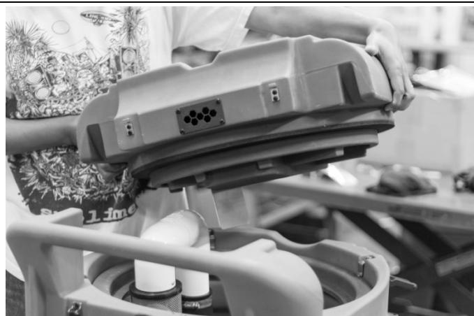
Afloje la abrazadera del cable en la pared interna del tanque con una llave inglesa de 15/16 pulgadas y recoja aproximadamente dos pies de cable o hasta que el cable presente resistencia.
