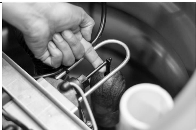
Repliez la poignée de la pompe et sortez la pompe pour l'inspecter. Placez la pompe sur une table ou toute autre surface stable à côté de l'appareil. Vous n'avez pas à débrancher le faisceau de câbles.
