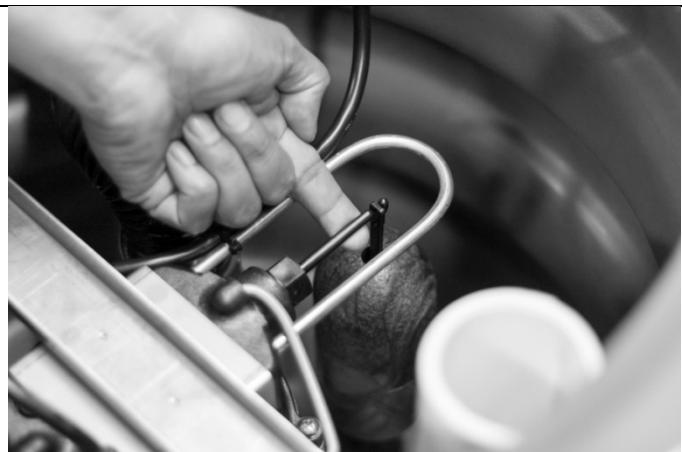
Pliegue la manija de la bomba hacia arriba y saque la bomba para inspeccionarla. Coloque la bomba sobre una mesa u otra superficie estable ubicada cerca de la unidad. No hay necesidad de desconectar el mazo de cables.
