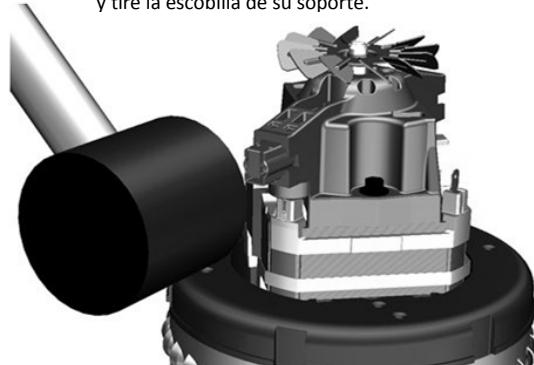
8. Usando un mazo de goma, golpee suavemente la escobilla hasta que calce con el extremo del soporte.
