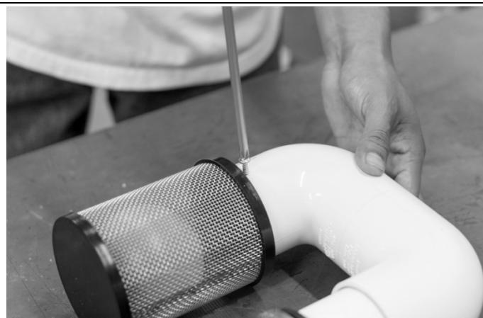
Desserrez le collier de serrage de la sortie supérieur de la pompe et retirez le tuyau de la sortie.
