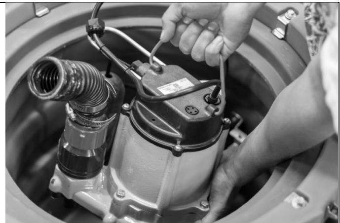
À l'aide d'un tournevis Philips, retirez la vis de rétention du couvercle de l'arrivée de la pompe et la plaque du fond de la pompe. Nettoyez tous le débris autours des arrivées. Replacez la plaque lorsque vous avez terminé.
